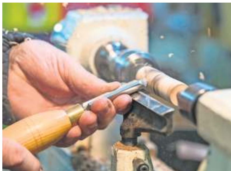
Fingerspitzengefühl: Aus kantigen Rohlingen werden auf der Drechselbank langsam runde Gehäuse für Kugelschreiber oder Füller.
